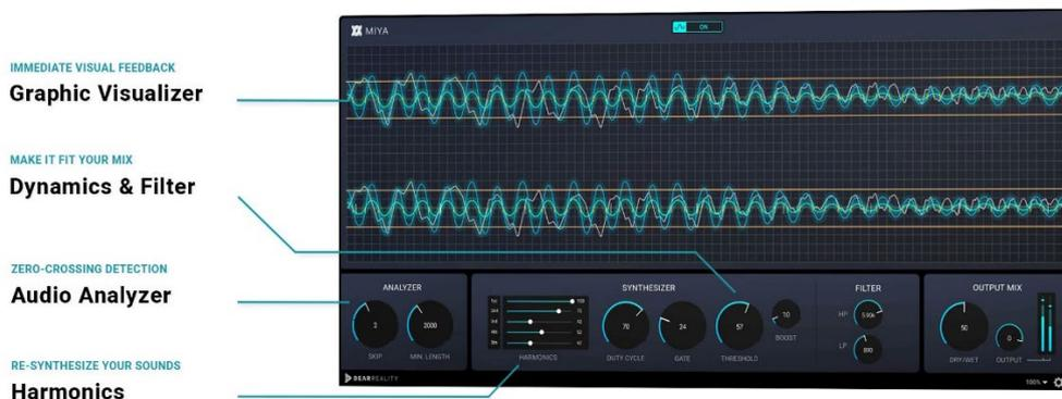
MIYA 配有实时观测器，可通过四种不同的颜色提供即时反馈。橙色短竖线表示所检测到的零点交叉位置，而灰线表示传入的原始信号。蓝线绘制生成的信号，绿线则直观显示插件的输出——湿信号与干信号的混合结果。
